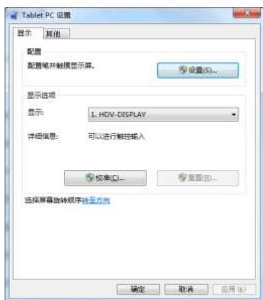
**步骤4** 用書寫筆點住在閃爍的“十”字遊標中心不動，直至閃爍的“十”字遊標移動到下一個定位點，這樣就完成了一個點的定位。根據定位介面中的提示照此方法依次操作完成定位。
