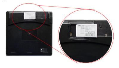
(2)鋰電池裝好後,將電池蓋按方向插入蓋緊。
