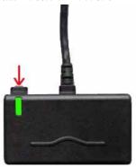
提示:接收器的指示燈閃動**15**秒後會自動熄滅。若此時您還未進行第**3**步操作。請再用手指按住 接收器上的按鈕約**3** 秒直至指示燈重新閃動。 3) 在接收器綠燈閃爍時·使用電子筆點住繪圖板背面的[CODE]筆觸孔。當接收器收到該繪圖板發出的連接信號後·軟體會彈出繪圖板無線添加視窗(如圖所示)。
